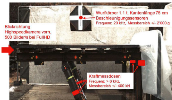
Seitenansicht Versuchsaufbau und Messtechnik für vertikale Fallversuche. Bild: Berner Fachhochschule BFH
